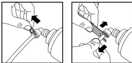
Утапливание цанги фитинга производится с помощью специального ключа: наденьте «вилку» ключа на трубку вплотную с цангой и утопите цангу в основание фитинга, надавив на неё ключом.
