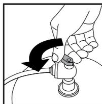
10) Откройте шаровый кран подачи воды к фильтру, включите вилку в электрическую розетку, проверьте герметичность соединений, откройте кран для чистой воды. Промыв фильтр в течение 15-30 минут, закройте кран для чистой воды. Откройте кран на накопительном баке. После наполнения бака фильтр отключится автоматически. Откройте кран для чистой воды и слейте воду из бака. Закройте кран для чистой воды. Фильтр подготовлен к работе и начнет производить чистую воду в автоматическом режиме.
