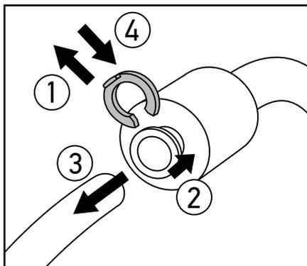
Последовательность действий при отсоединении шланга:
