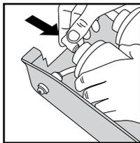
6) Установите в зажимы новый фильтрующий элемент. Внимание! Соблюдайте направление движения воды согласно стрелке на этикетке фильтрующего элемента.
