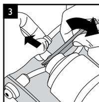
3) Снимите входной и выходной фитинги с фильтрующего элемента предварительной очистки К870. Для этого на каждом фитинге утопите цангу с помощью ключа и стяните фитинг с патрубком фильтрующего элемента.
