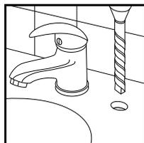
■ Просверлить отверстие под кран (5С) в мойке и установить его. Сверление отверстия в мойке следует выполнять только в том случае, если имеется уверенность, что мойка не будет разрушена при этой процедуре. Особую осторожность следует проявить при сверлении отверстий в керамических, фарфоровых, гранитных, мраморных, тефлоновых, из искусственного камня и проч. мойках. При невозможности сделать отверстие в мойке, кран можно установить также в столешнице либо навесить на стену на кронштейне.
