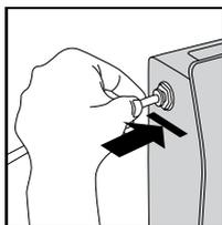
Для этого втолкните трубку в фитинг до упора. Шланг/патрубок должен войти в фитинг на глубину 15-18 мм.
