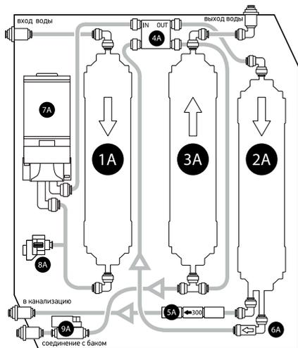
Рис. 2. Схема основного блока системы Expert Osmos.
