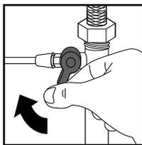
Для перевода системы в рабочее состояние откройте кран подачи воды (1С) и кран на накопительном баке (3С), закрой-
