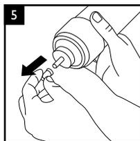
5) Извлеките новый фильтрующий элемент K870 из технологической упаковки, снимите с патрубков защитные колпачки.
