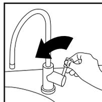
Если система используется впервые, дважды наберите полный бак очищенной воды и слейте ее через кран для чистой воды. Только после этого очищенную воду можно употреблять для питья.
