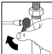
те кран для чистой воды (5С). Система готова к работе и начнет производить чистую воду в автоматическом режиме.
