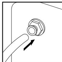
Первым отрезком соединяют тройник (1С) с фитингом «ВХОД ДЛЯ ВОДЫ» на боковой панели основного блока фильтра (2С).
