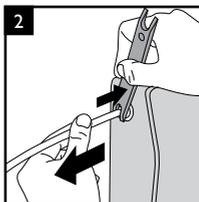
2) Отсоедините пластиковые трубки от входного и трех выходных фитингов на корпусе фильтра. Для этого утопите цангу с помощью ключа, вытяните трубку.
