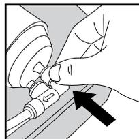
9) Закройте крышку фильтра. Установите фильтр на место и подсоедините пластиковые трубки к входному и трем выходным фитингам.
