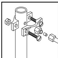
■ Просверлить отверстие в сливной трубе мойки (в сифоне **выше уровня канализационного водяного затвора**) и подсоединить к трубе дренажную муфту (4С).
