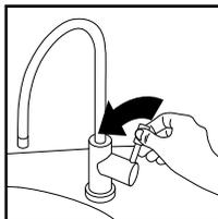
1) Перекройте подачу воды к фильтру, выньте вилку из электрической розетки, закройте кран на накопительном баке и откройте кран для чистой воды.
