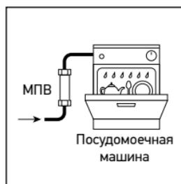
Рис. 1 Возможные места установки МПВ А032
