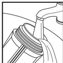
3. Промойте корпус и крышку фильтра водопроводной водой.
