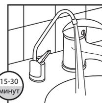
10. Закройте кран (8) на накопительном баке, откройте кран для чистой воды (11), откройте кран промывки (6), откройте подачу воды краном (1) на 15-30 минут. Это требуется для промывки картриджа от угольной пыли. Подробно процедура первичной промывки описана в разделе «Первоначальная промывка».
