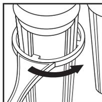
5. Наверните корпус с картриджем на крышку рукой до упора, а затем затяните с помощью ключа. Повторите процедуры 1-5 для оставшихся картриджей.
