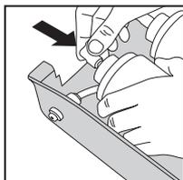
Наденьте входной и выходной фитинги на патрубки фильтрующего элемента до упора.
