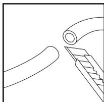
При монтаже пластиковая трубка (шланг) разрезается на 6 частей (длина частей выбирается на месте).
