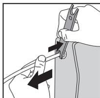
■ Отсоедините пластиковые трубки от входного и трех выходных фитингов на корпусе фильтра. Для этого утопите цангу с помощью ключа, вытяните трубку.
