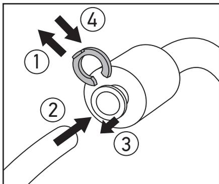
Последовательность действий при подсоединении шланга (патрубка):
