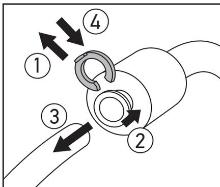
Последовательность действий при отсоединении шланга (патрубка):
