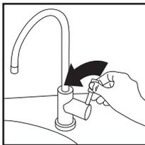
■ Сбросить давление внутри водоочистителя, открыв кран для чистой воды, и дождаться слива из него части оставшейся в водоочистителе воды.
