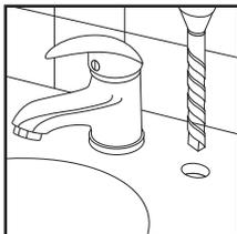
невозможности сделать отверстие в мойке, кран можно установить также в столешнице либо навесить на стену на кронштейне.
