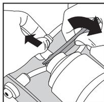
■ Снимите входной и выходной фитинги с фильтрующего элемента предварительной очистки K870.
