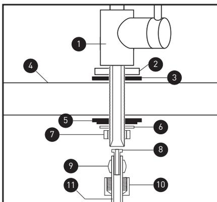
1 - кран чистой воды; 2 - диск-подставка; 3 - резиновая прокладка; 4 - мойка / столешница; 5 - пластиковая шайба и резиновая прокладка; 6 - шайба; 7 - гайка; 8 - штуцер; 9 - втулка; 10 - гайка; 11 - пластиковая трубка
