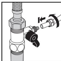
Вторым отрезком (2) соединяют выход помпового блока «к системе RO» с входом блока фильтрации «Prio Jet».
