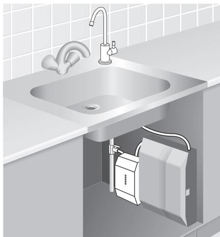
Рис.1. Пример установки фильтра Expert Osmos.
