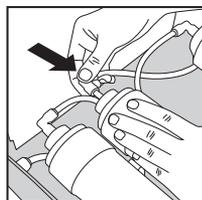
■ Замена обратноосмотической мембраны K858 проводится аналогично операциям по замене фильтрующего элемента K870. Внимание! На центральный выходной патрубок обратноосмотической мембраны надевается угловой обратный клапан. На боковой выходной патрубке надевается фитинг, который соединяется с выходом воды «концентрат»
