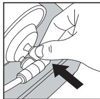
■ Закройте крышку фильтра. Установите фильтр на место и подсоедините пластиковые трубки к входному и трем выходным фитингам.
