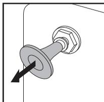
Перед установкой шлангов удалите все заглушки из фитингов блока фильтрации и помпового блока. Процедура удаления заглушек и подключения/отключения шлангов к фитингам описана в разделе «Подключение шлангов и патрубков фильтрующих элементов к фитингам».
