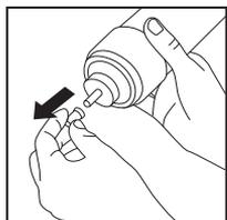
■ Извлеките новый фильтрующий элемент K870 из технологической упаковки, снимите с патрубков защитные колпачки.
