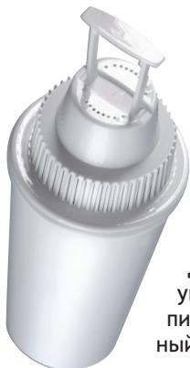
Фильтрующий картридж — сердце фильтра-кувшина — является продуктом высоких технологий. В его состав входит специально подобранная смесь шунгита, высококачественного активированного угля из скорлупы кокосовых орехов, ионообменных смол и бактериостатических присадок на основе серебра.
